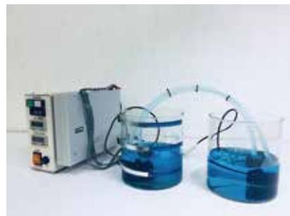
静電センサフィルムを用いた水位検知センサです。静電容量検知とは世の中に一般的にあるタッチパネルの仕組みです。デモ機では容器の外側に貼りつけたセンサシートの高さに中の液体が達すると静電容量の変化を検知し、シートに実装したLEDと本体のインジケータが光って知らせます。
